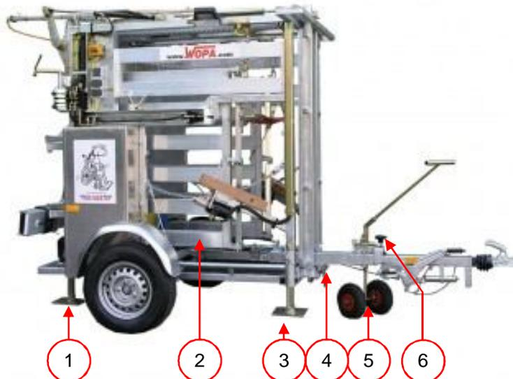
**Abbildung 4: Übersicht des Umbaus von Transportstellung in Arbeitsstellung (SA0051)**
